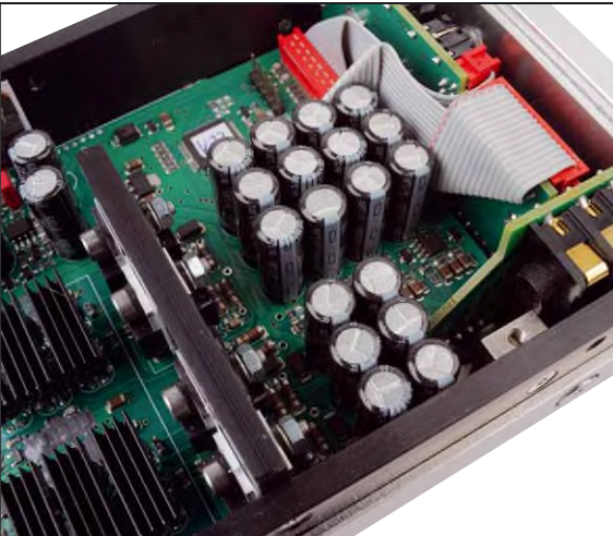
Direkt „vor Ort“ sorgen selektierte Kondensatoren für perfekte Spannungsstabilität, insbesondere für den leistungsfähigen Kopfhörerverstärker
